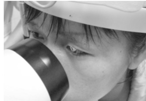
图5 根据照明光在角膜上的反光确定相机前后位置。
